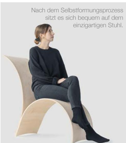
Beim HygroShape-Konzept wird frisches Holz furnier in unterschiedlich dicken Schichten zusammengeklebt. Die einzelnen Lagen werden dabei in 0 Grad und 90 Grad zur Faserrichtung des Holzes gedreht. Der nun entstandene sogenannte „Bilayer“, also die „Doppelschicht“, verbiegt sich durch den Widerstand
