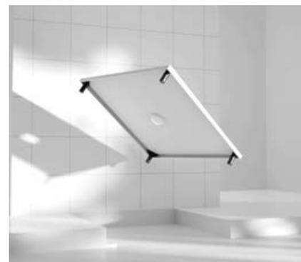
Kunststoff-Zylinder werden in den Ecken der Duschwanne verklebt, diese wird am Montageort aufgestellt und vom Profi zwischen 80 und 200 mm auf die Wunschhöhe angehoben, wobei die Systemfüße automatisch arretieren.
